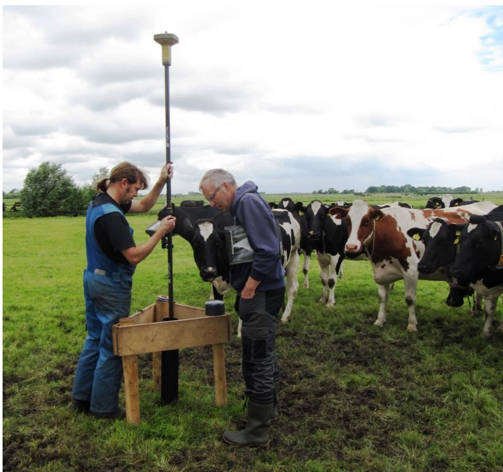
Afbeelding 1. Grondwaterpeilbuis plaatsen. Foto: Annette van Schie.
