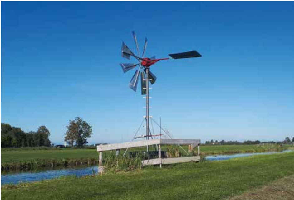
Afbeelding 1: Deze windmolen in Spengen is een voorbeeld van innovatie door een boer. Met windkracht kan zonder stroomaansluiting en zonder zonnepanelen actief water in het infiltratiesysteem gepompt worden. De drukhoogte kan ingesteld worden en ook zonder wind wordt in elk geval passief water ingelaten. De capaciteit is veel groter dan met zonnepanelen.
