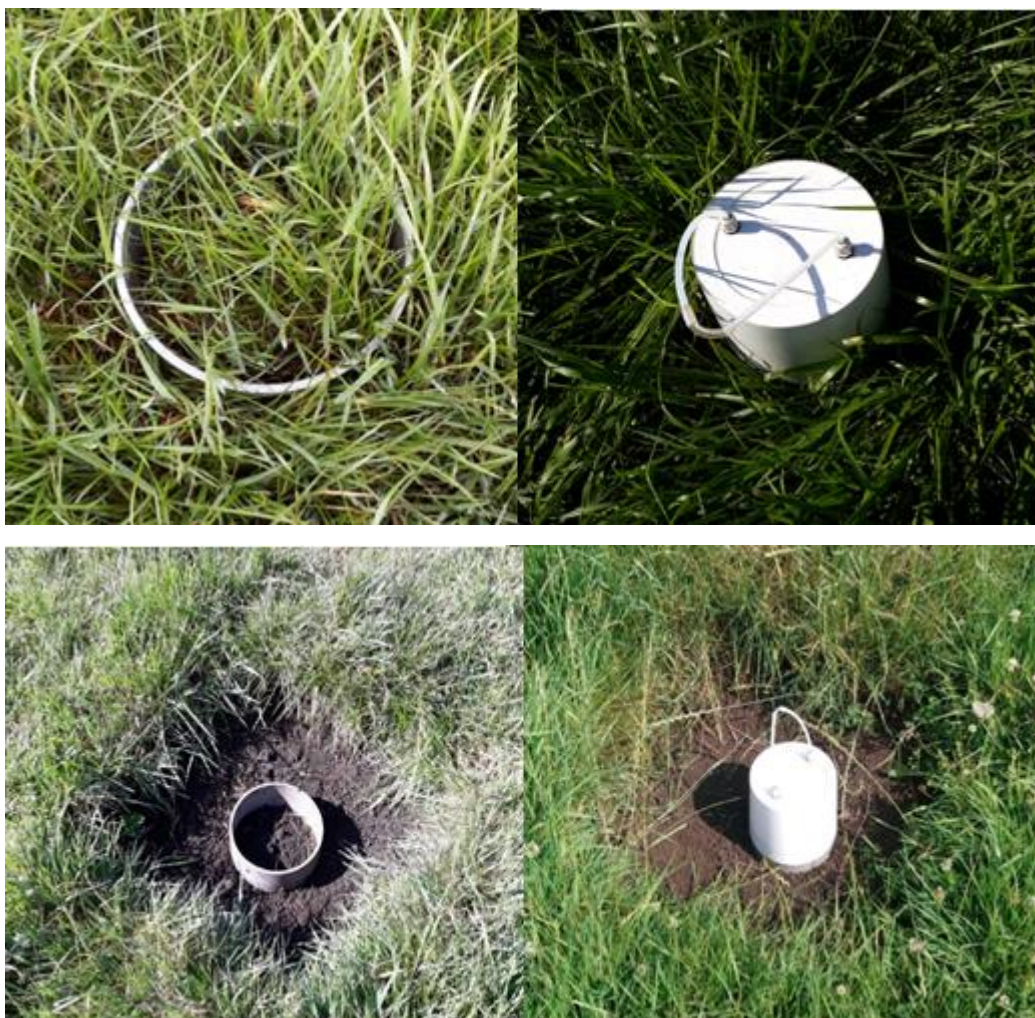
Figuur 2.65. Installatie van de pvc ringen en fluxkamers op N0 en N1 veldjes (bovenste foto's) en ZZ veldjes (onderste foto's).
