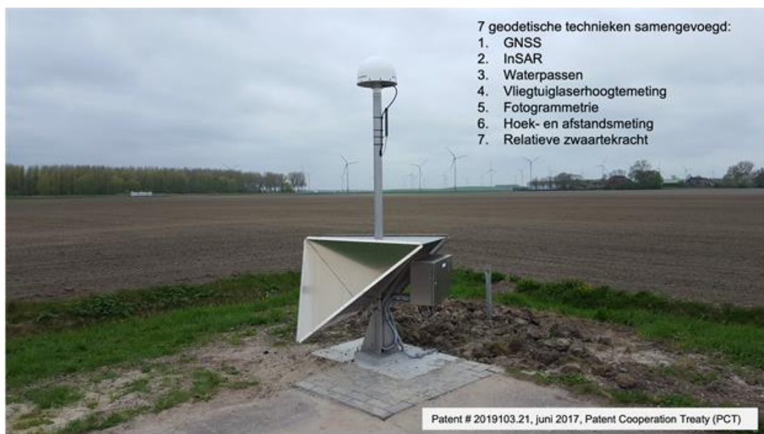
Figuur 3.36. Voorbeeld van een Integrated Geodetic Reference Station (IGRS). Een IGRS maakt het mogelijk om metingen met zeven verschillende geodetische technieken te integreren.
