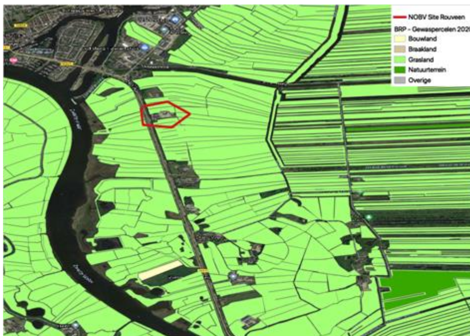
Figuur 3.46. Perceelgrenzen voor een gebied rondom Rouveen. In de vervolgstappen zullen deze perceelgrenzen gebruikt worden in de InSAR analyse, om zo tot een homogenere selectie van radarreflecties te komen voor het schatten van maaiveldbeweging.
