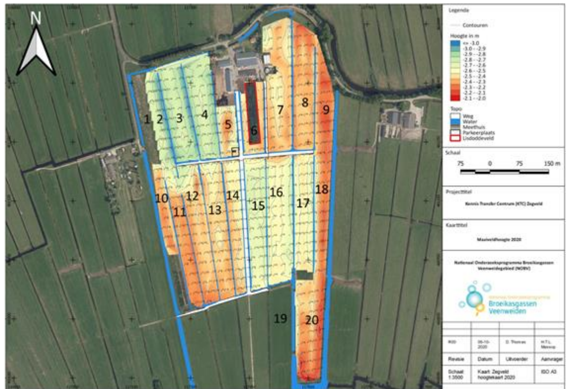
Figuur 2.48. Hoogte proefboerderij Zegveld in 2020, in meter NAP. Nummers 1-20 zijn perceel nummers.
