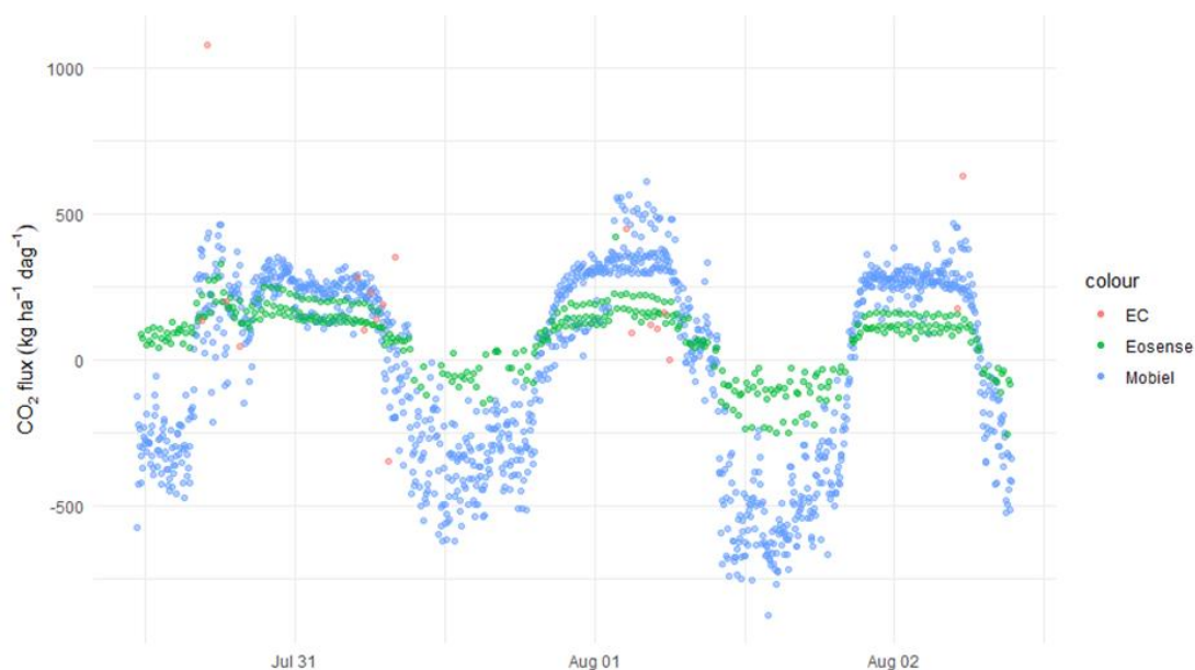
Figuur 3.68. CO 2 fluxen van Eosense kamers, mobiele kamers en, wanneer beschikbaar, eddy covariance (EC) in het maatregelplot van Aldeboarn.
