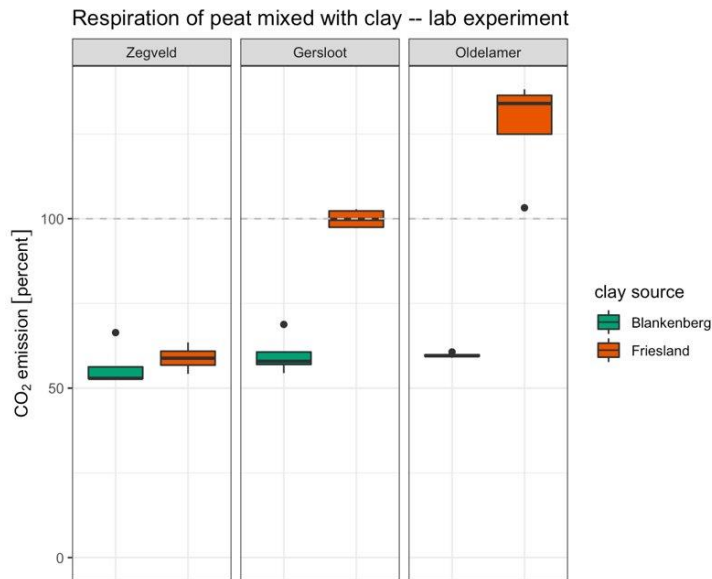
Figuur 3.17. Effect van klei type (Blankenberg en Friesland klei) op de afbraak van veen uit Zegveld, Gersloot en Oldelamer één jaar na inmenging.
