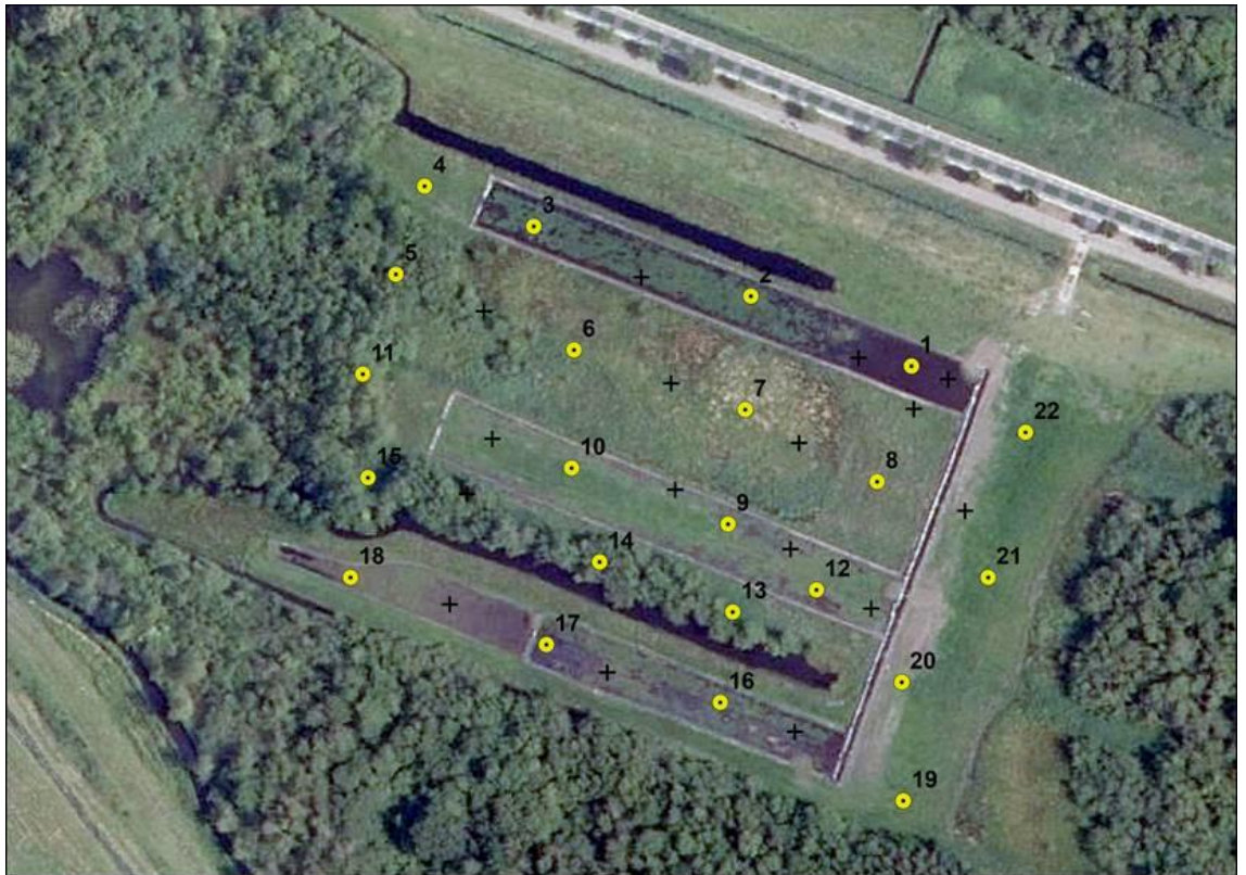
Figuur 3.58. Ligging en nummering van de grondboringen. De met een + aangeduide locaties zijn boringen van Deltares.
