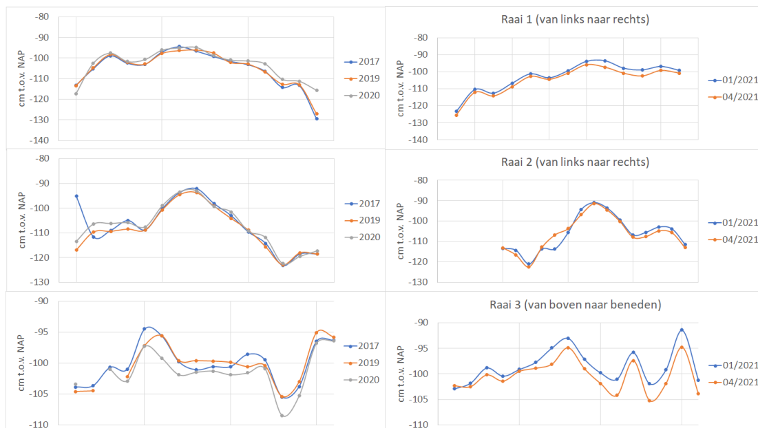
Figuur 2.5. Maaiveldhoogte in het referentieperceel van Aldeboarn, behorend bij het (inmiddels afgelopen) OWD-onderzoek van de provincie Fryslân. Rechts metingen in 2021. De y-as geeft maaiveldhoogte in cm t.o.v. NAP. De locatie van de raaien is te zien in Figuur 2.4. De grafiektitel geeft aan in welke richting de meetpunten per raai in het kaartje van Figuur 2.4 (raaien binnen oranje cirkel) corresponderen met die in de grafiek.
