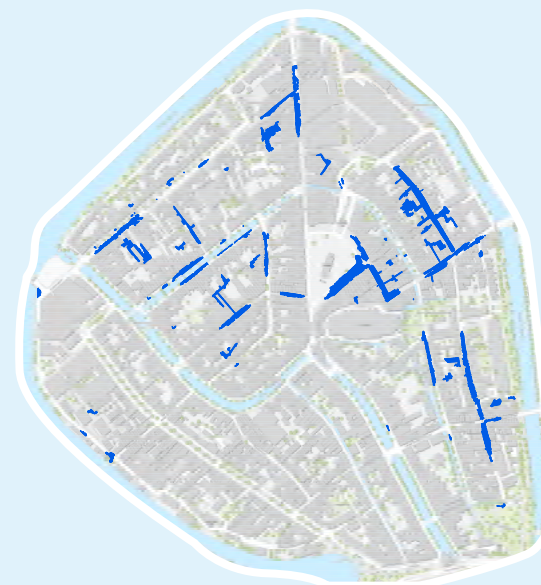
water op straat 2050 bij alleen rioolvervanging
