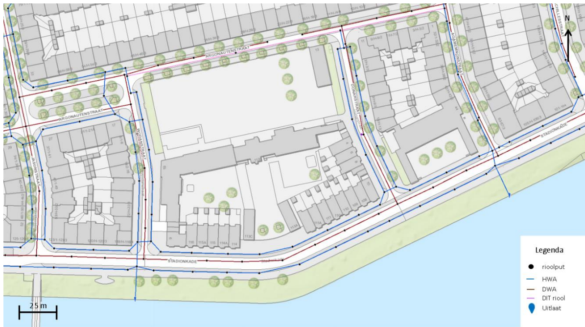
Figuur 17 Schematische weergave HWA, DWA en DIT riool.
