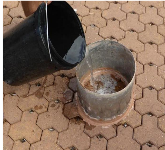
Figuur 6 De enkele ringinfiltrometer (Lucke et al., 2015).
