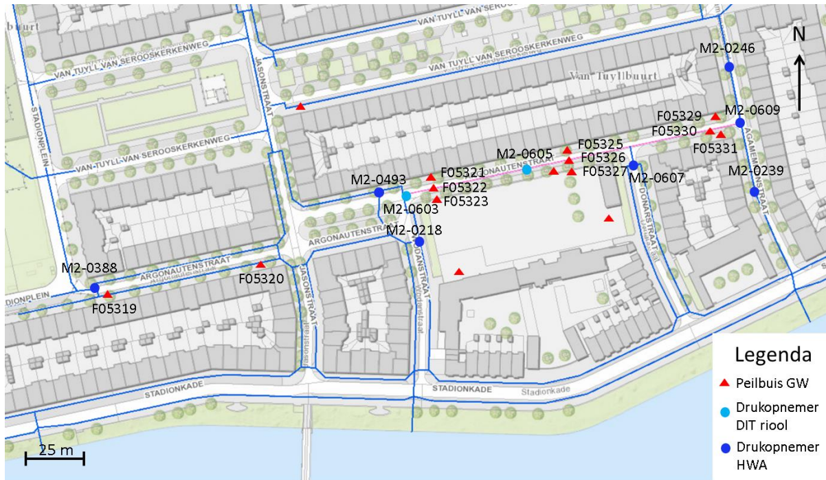
Figuur 16 Meetnet van peilbuizen en drukopnemers in en rondom de Argonautenstraat.
