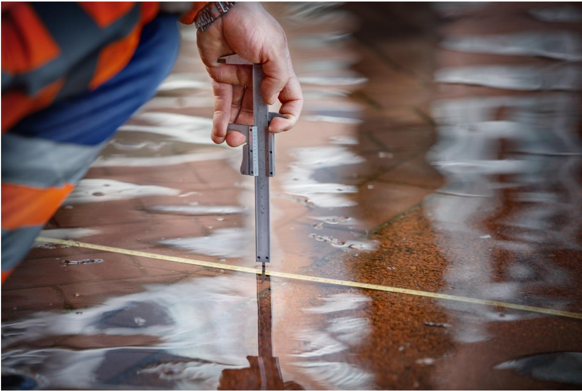
Figuur 20 Impressie van de handmatige hoogtemeting van de waterlaag op straat (Waternet, 2016).
