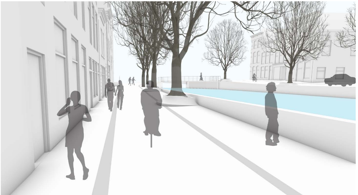
Ontwerp voor oplossingsrichting 2: kademuur verhogen
