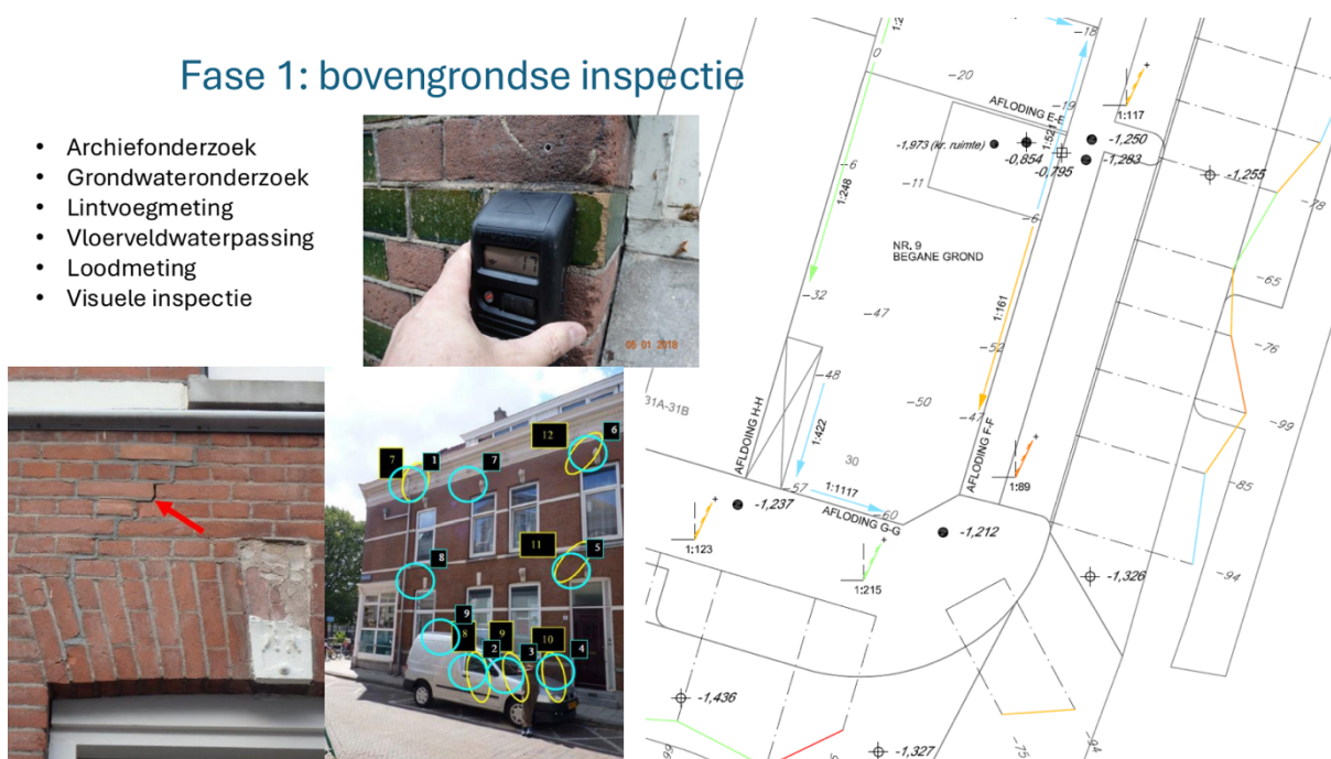
Figuur D1: Bovengrondse inspectie (Havensteder, 2025).
