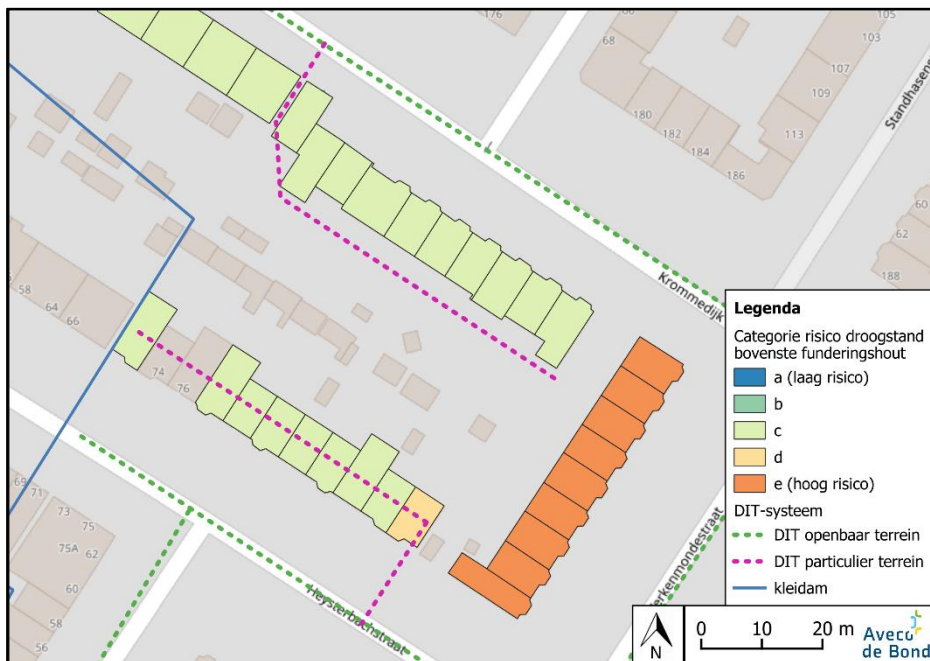
Risico droogstand funderingshout tijdens funderingsinspecties [6].
