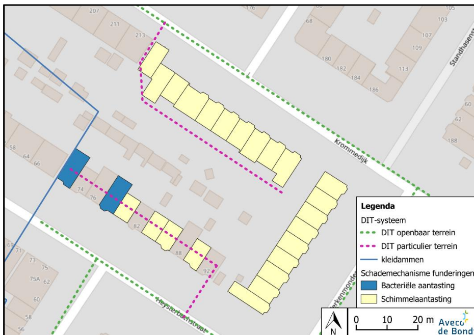
Geconstateerde schademechanismen tijdens de funderingsinspecties van de woningen [6].
