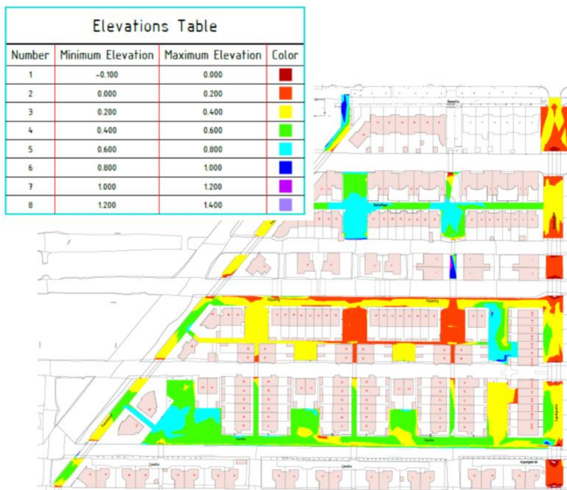
Figuur 6.3 Zettingsverschillen in Waterrijk-Oost.
